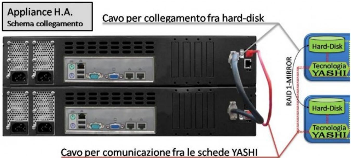
**Focus on:** I cavi di collegamento fra i due moduli, come da schema riportato:
